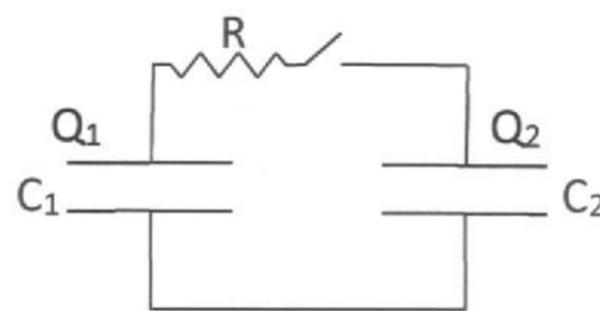
Alla fine del processo, all'equilibrio, la d.d.p. ai capi delle due capacità sarà la stessa; le due capacità sono equivalenti al loro parallelo.
